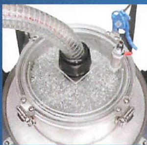
中が見やすい透明アクリル製のろ過タンク上蓋
