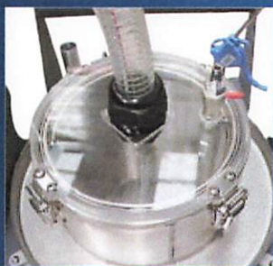
中が見やすい透明アクリル製のろ過タンク上蓋
