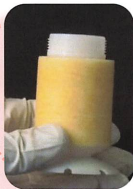
汚れたフィルタエレメント
