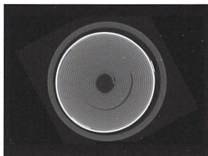
リチウムイオンバッテリー (225kV)
