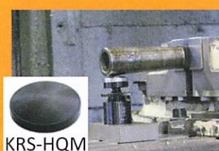
ワークサポーターを装着して 異形ワークにも幅広く対応。
